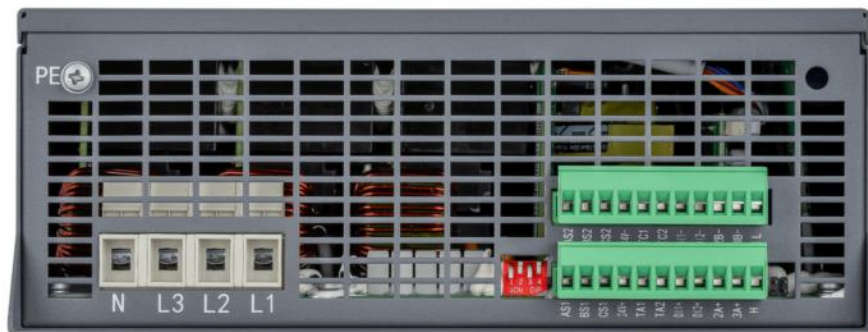
Rys. 2 — widok urządzenia od góry: listwa zasilania (N, L3, L2, L1), zacisk PE oraz listwa wejść/wyjść sterowania i przekładników.
